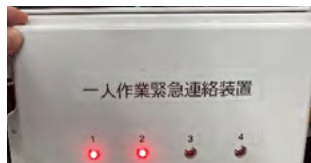
工場内作業者への緊急連絡装置の導入
